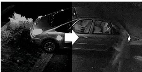
Diese Funktion (auch Sens-Up genannt) hilft, bei schwacher Beleuchtung ein helles, klares Bild zu erhalten. Die Funktion verlängert automatisch die Verschlusszeit soweit erforderlich, maximal bis zu einem eingestellten Faktor.
